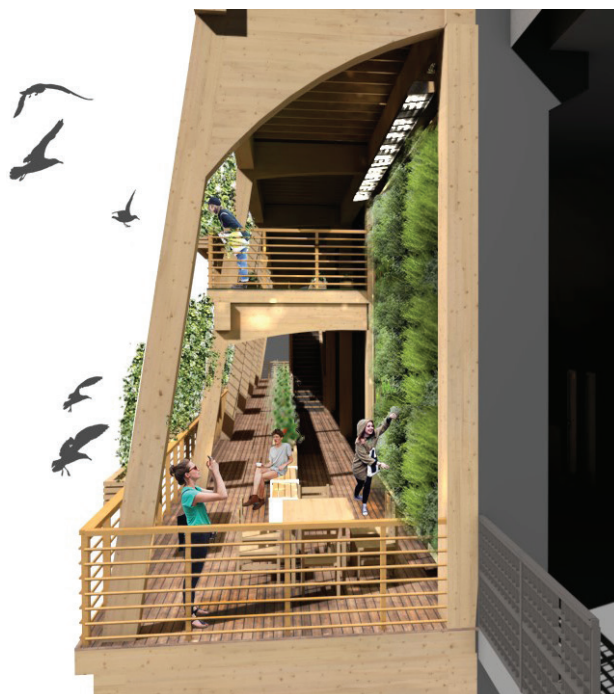
Illustrasjon 23. Bygging av svalganger i limtre utenpå eksisterende konstruksjon vil øke publikumsarealet og kunne gjøre dem triveligere. (Illustrasjon: Halvdan Rosted)
